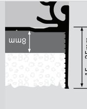
Styrodurplatte 8 mm (A) mit 15 bis 25 mm Putzwinkel (B).
