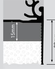
Styrodurplatte 15 mm (A) mit 30 mm Putzwinkel (B).
